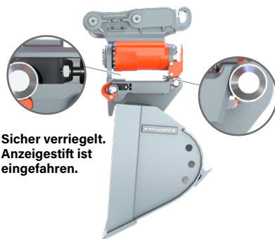
Entriegelt für den Kupplungsvorgang. Anzeigestift ist ausgefahren.
